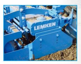
• 可调节高度的左右侧档板可以防止最外面的耙 齿在作业时构筑垄沟。
